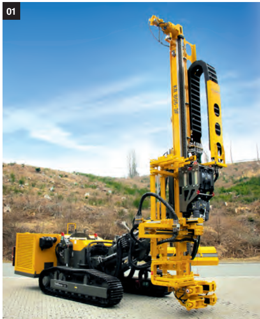
01 Bohrgeräte // Drill rigs
